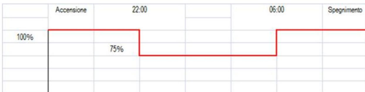
Figura 2. - Schema fornito dal Gestore della strada per la riduzione automatica del flusso.
