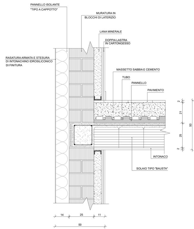
**PARTICOLARE ISOLAMENTO STRUTTURE**
