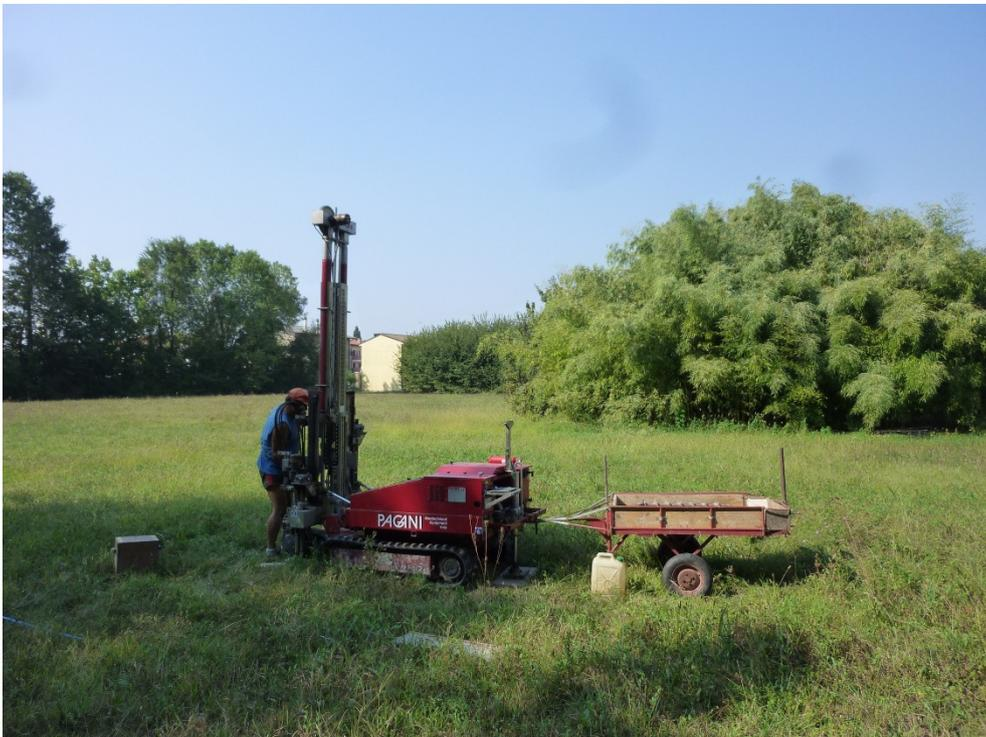
**Fig. 4 - Esecuzione prova CPT4**
