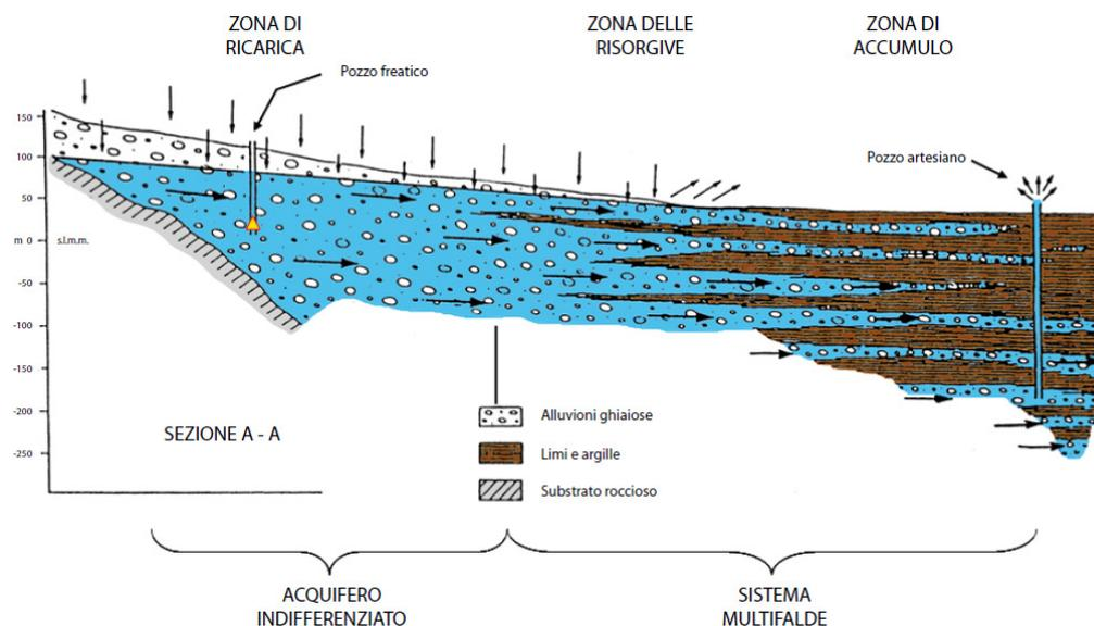
Figura 7 – Schema idrogeologico dell'alta e media pianura veneta.
