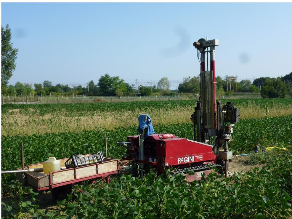
**Fig. 1 - Esecuzione prova CPT1**
