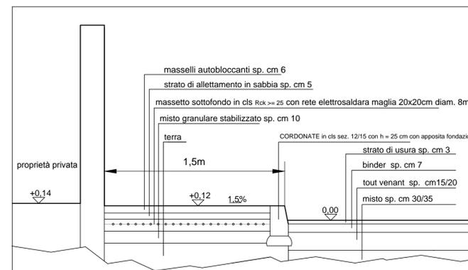
SEZIONE TIPO DI PROGETTO scala 1:20
